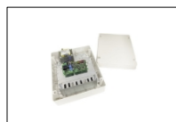
B71/PBX36/BOX/115 Hybridní měnič, verze "Network Assisted", pro napájení automatizace. Poskytuje také funkci nabíječky baterií díky připojení k solárním panelům nebo síťovému napájení pro napájení bezkartáčových digitálních regulátorů 36 V DC se síťovým napětím 115 V AC.
